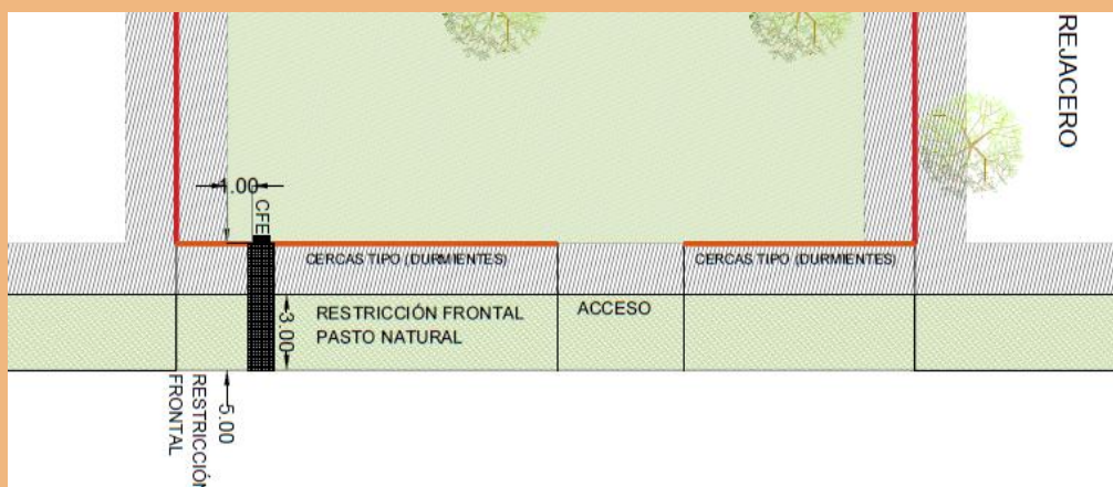
Fig. No.6.1 Croquis Ubicación Medidor de CFE
